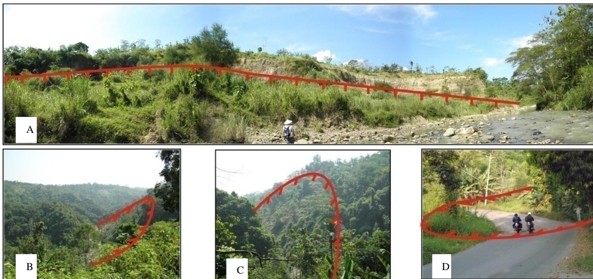
Gambar 4. Keberadaan gawir sesar dan longsor di sepanjang lembah Kali Garang. A) Gerakan tanah dengan mahkota longsor yang cukup besar dengan dimensi panjang sekitar 100 m yang memperlihatkan bagian teras sungai yang terpotong pada ketinggian sekitar 15 m dan terdapat rembesan mataair, B) gawir sesar Kali Garang di daerah Banyumanik dengan gawir yang terjal, sempit, dan terlihat lurus memanjang searah dengan kelurusan sungai, C) indikasi gerakan tanah rayapan ( creeping ) di daerah Banyumanik, D) gerakan tanah rayapan dengan arah gerakan menuju badan Kali Garang.
