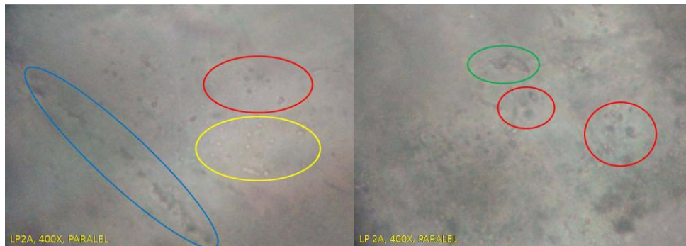
Gambar 3. Fotomikrografi inklusi fluida urat kuarsa kristalin Sungai Simpes, terdiri dari inklusi primer fasa tunggal kaya air (lingkaran kuning) dan sebagian dua fasa (lingkaran merah), dua fasa bentuk anhedral necking (lingkaran hijau), dan inklusi sekunder terdistribusi di dalam zona retakan mikro berupa anhedral dua fasa yang sudah rusak (lingkaran biru)
