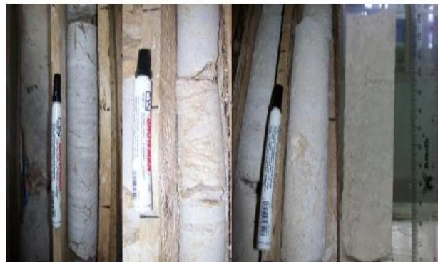
Gambar 3. Retakan Batugamping pada Core
