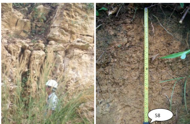
Gambar 3. Profil bagian atas batugamping dan tanah penutup
