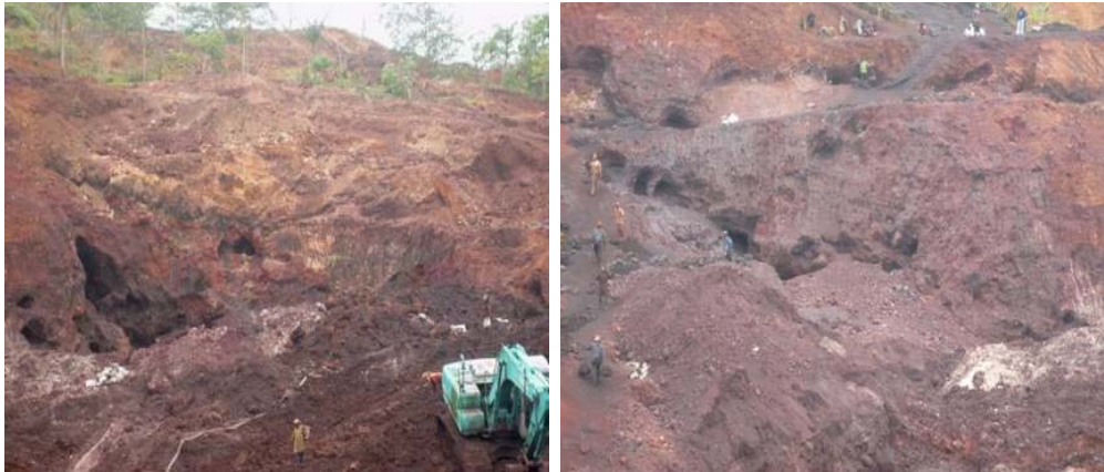
Gambar 1. Foto singkapan endapan mangan tipe oksisol di daerah Karangnunggal, berwarna merah coklat bercak hitam, beberapa lapisan dan lensa tipis bentonit tampak berwarna putih
