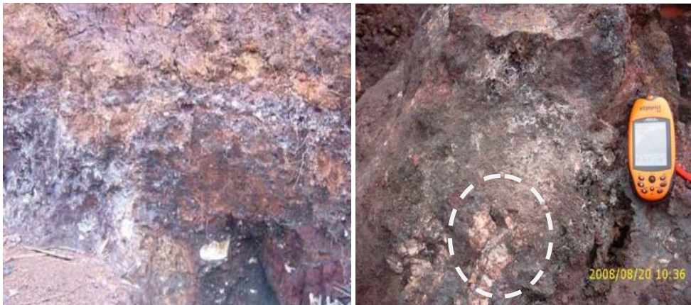
Gambar 2. Foto singkapan endapan mangan memperlihatkan tekstur breksi hidrotermal yang telah mengalami pelapukan (kiri) dan bongkah silikasi batuan yang mengandung urat kuarsa bermangan (kanan)
