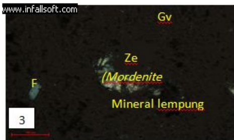
Fotomikrografi 3. Zeolit (Ze) Cimade, menunjukkan struktur radier dan sebagian berbentuk jarum yang diidentifikasi sebagai mordenit, dan mineral sekitarnya gelas vulkanik (Gv), dan felspar (F). Ukuran Kristal (0,02-0,2) mm, terdiri dari felspar dan kuarsa dalam jumlah sangat sedikit ( 5%). Lokasi Kampung Cimade, Cikanra
