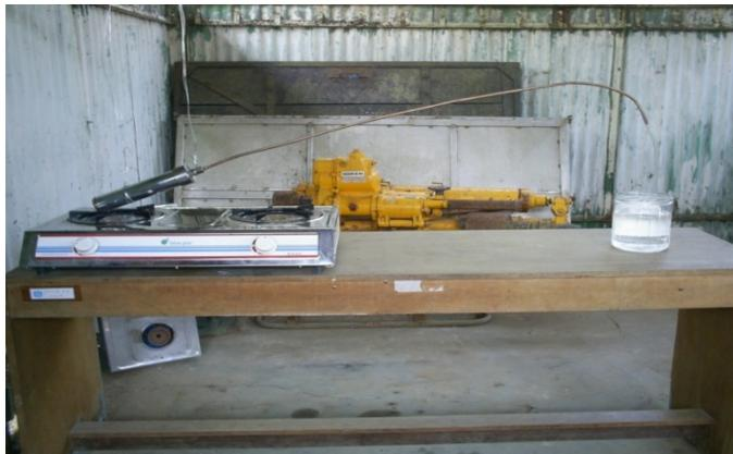
**Gambar 2.** Percobaan Pembuatan Semikokas dari Batubara Garut di UPT Loka Uji Teknik Penambangan Jampang Kulon LIPI, Sukabumi
