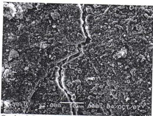
Gambar 8. Permukaan batubara (-3+7) mesh setelah pendinginan suhu beku air selama 48 jam (2000X). Percobaan no 3.
